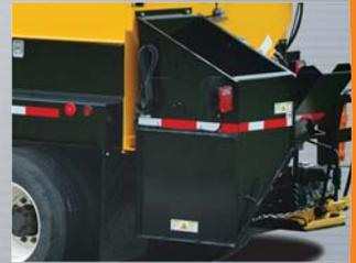
**Tanque aislado de riego de adherencia** – Dispone de una banda calefactora eléctrica en la parte exterior del tanque que elimina los daños de la emulsión y proporciona un calentamiento suave e indirecto de las emulsiones asfálticas.
